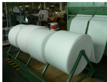
Abzugs- und Schneidvorrichtung für die Verarbeitung von Vliesstoff
